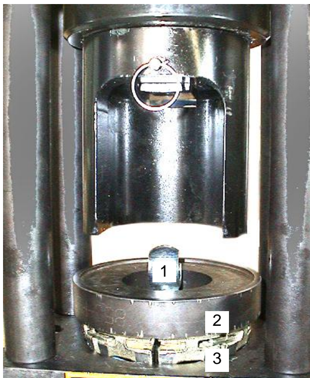
Obrázek 3-3 Koncovka, kroužek čelistí a sada čelistí
